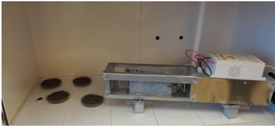
Рис. 4 – Ламинарный бокс с экспериментальной установкой и образцами (комбикорм)
