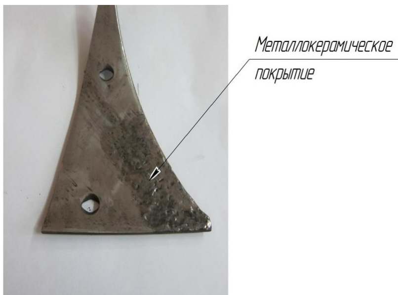
Рис. 5 – Грудь отвала плуга Multi Master 112 компании KUNN, упрочненная КВДУ, после наработки 65 га
